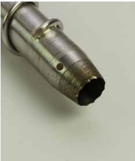
Borinn er beittur og tenntur og rennur þannig auðveldlega inn í rúlluna
